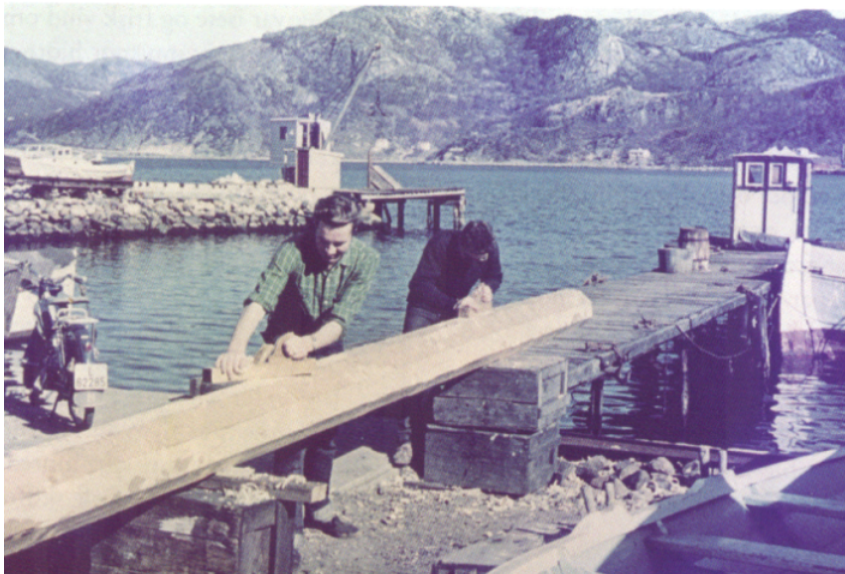
Høvling av ny stormast for å lage den rund
