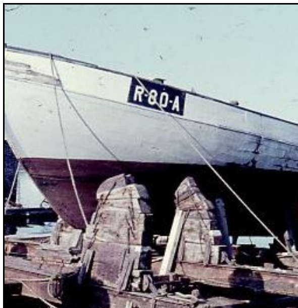
Skøyta på slipp for å sette på kjøll
